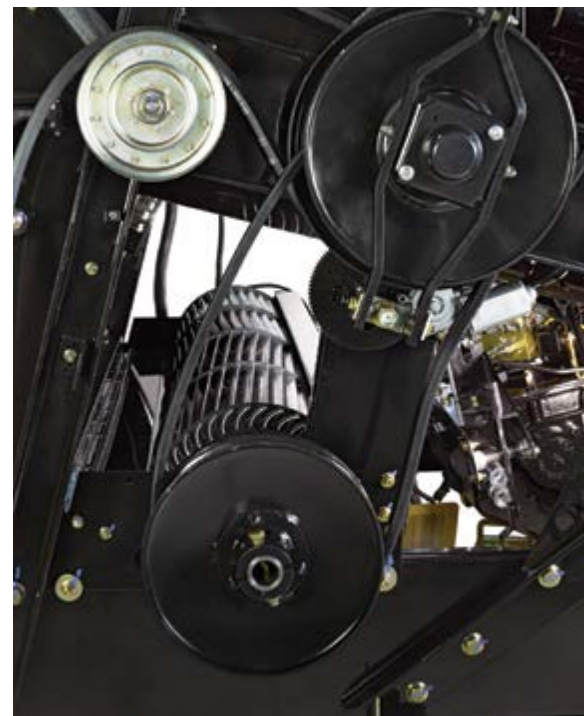
Sistema Cross Flow con captación de aire por la parte superior del ventilador
